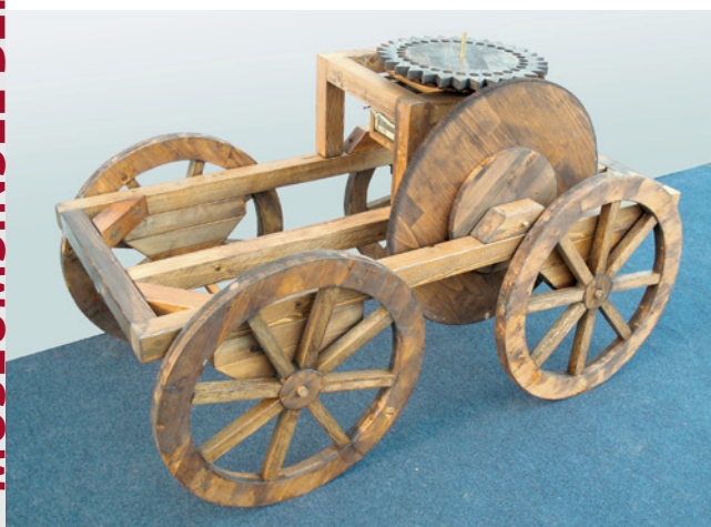
Abb. 5 Nachbau eines römischen Messwagens (Hodometer) zur Streckenvermessung mit einem genormten Rad-durchmesser von vier Fuß, Holz, 150 x 110 cm, Privatsammlung Florenz.
